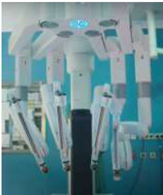
Laparoskopischer Turm (Patientenwagen) des DaVinci für die Kamera und 3 Instrumente.
